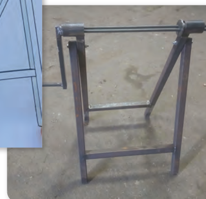
Enrouleur pour bache d'un crapaudrôme (croquis et réalisation) © M. GEORGES
