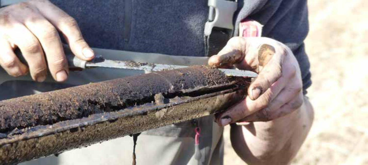
*Carotte réalisée pour une analyse pédologique*
