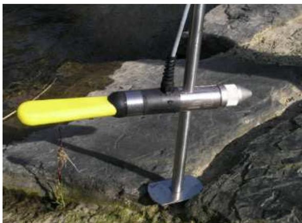
Figure 16 : Courantomètre utilisé (OTT)
