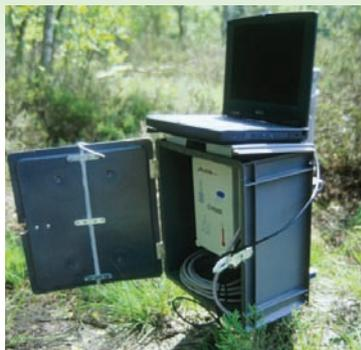
*Station automatique des suivis des niveaux d'eau*
