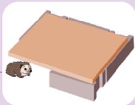
Mesurez les côtés du rectangle formé par les parpaings et découpez plusieurs planches permettant de le recouvrir.
