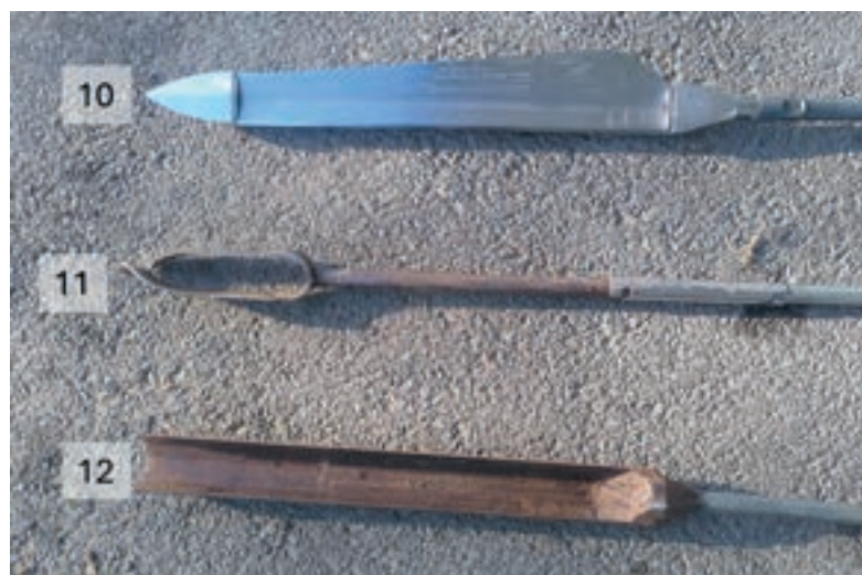
Matériel pour prélèvement de sol en tourbière. Le trou résultant du prélèvement peut être utilisé pour placer le tube du piézomètre et son dispositif d'ancrage. 10 : carottier russe, 11 : tarière Edelman, 12 : tarière gouge ©A. BERQUER, CEN HDF
