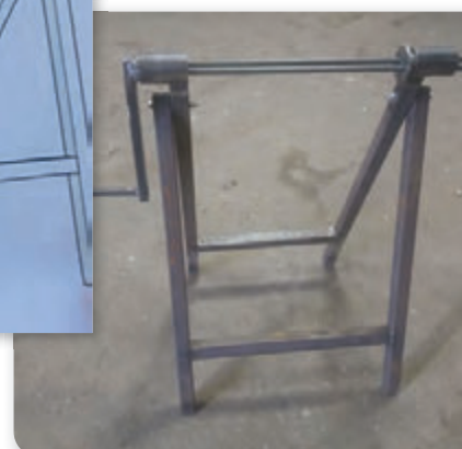
Enrouleur pour bâche d'un crapaudrôme (croquis et réalisation) © M. GEORGES
