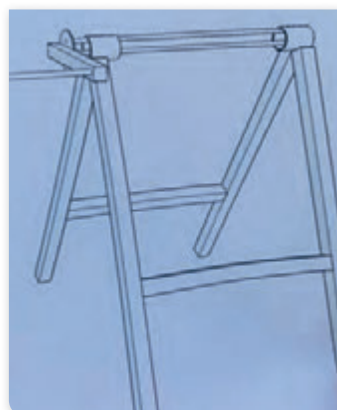
Enrouleur pour bâche d'un crapaudrôme (croquis et réalisation) © M. GEORGES
