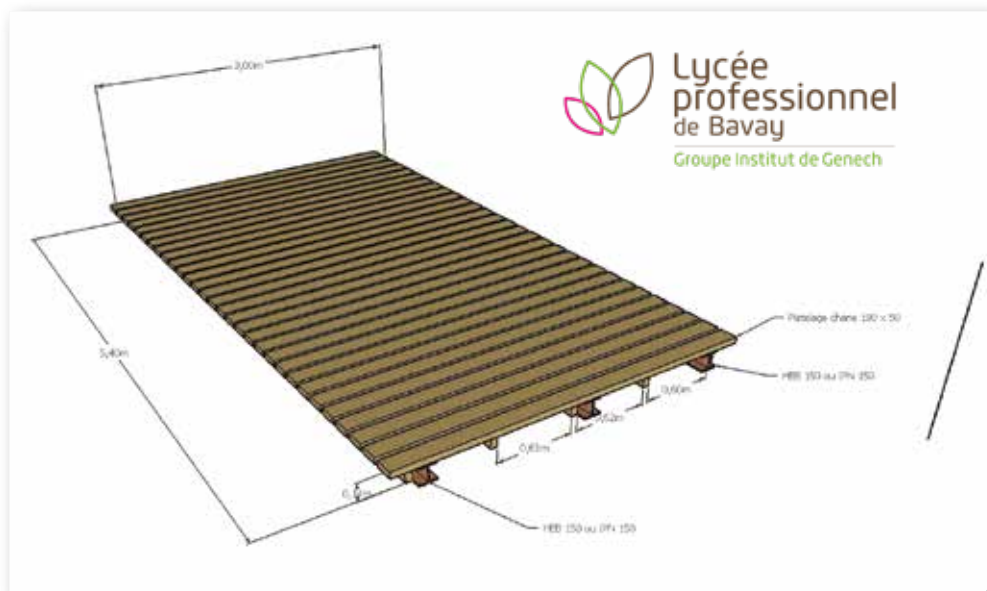
Schéma pour la fabrication de la passerelle technique
